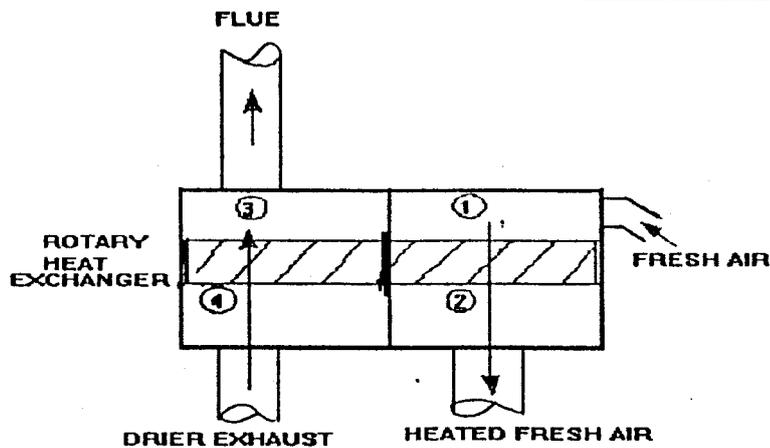
FIG 1. WASTE HEAT RECOVERY SYSTEM
